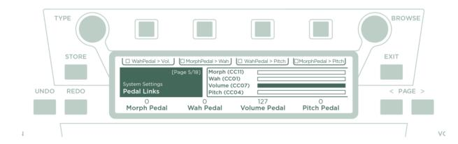
このページでは、接続したペダルの動作確認が行えます。接続されたペダル全ての現在値がバーで表示され、ペダル操作にリアルタイムで反応します。期待どおりに反応しない場合は、ペダルの機能アサインが正しく行われているかや、ケーブルやペダルそのものが正常に機能しているかなどをご確認ください。
