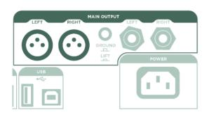
ステージやスタジオでは、キャビネットの前にマイクをセットするのではなく、プロファイラーの MAIN OUTPUT をミキサーに接続してください。
