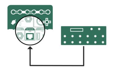
プロファイラー・リモート(以下:リモート)をご使用の場合は、付属のイーサネット・ケーブルを使って、本体リアパネルの NETWORK 端子に接続してください。
