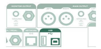
あなたのプロファイラーを常に最新の状態にする ために、下図のように、あなたのプロファイラー とパソコンを USB ケーブルで接続してくださ い。
